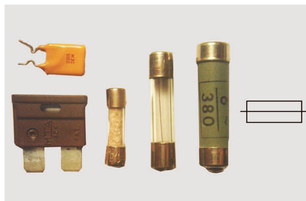
Fig. 108 Sopra, esempi di fusibili e relativo simbolo grafico.
